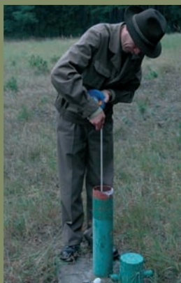
Pomiar lustra wody w piezometrze przed modernizacją fot. Radosław Skórkowski
